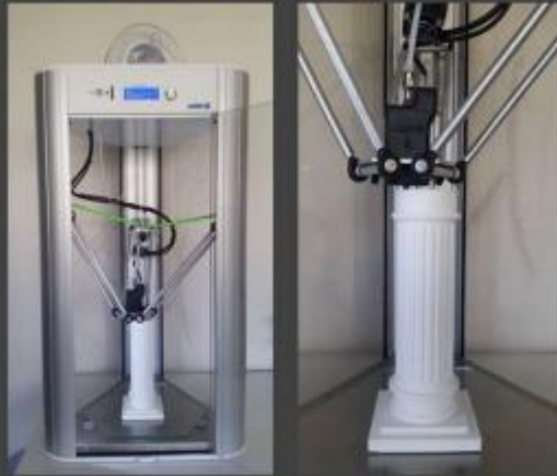
Realizzazione di modelli in scala mediante stampa 3D
